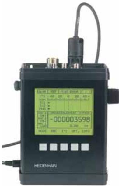
**PWM 8**是一种通用测量仪，用于检验和校准海德汉增量光栅尺和编码器。为了适应不同输出信号，有相应的扩展模块。小LCD屏幕用作显示，可方便地通过软件按键操作。
